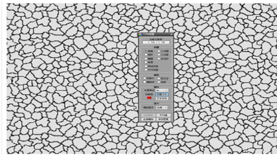
软件提供了距离、矩形、圆形、多边形、折线长度、角度、直线夹角、弧度，点到圆心测量等多种测量工具，来满足用户的基本几何测量功能，得到相关测量数据。
